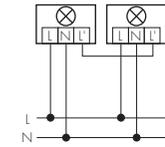
Il ne faut jamais faire fonctionner plus de 5 luminaires en parallèle. Avec des quantités supérieures, des déclenchements intempêtifs peuvent se produire davantage, par ex. en raison de la taille et/ou de l'imprécision de la zone de détection.
