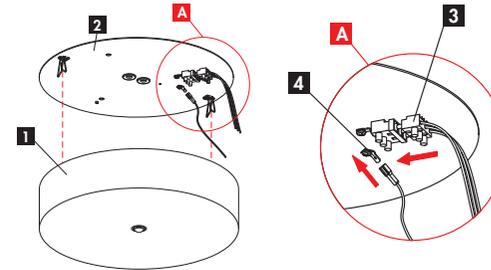
1. Couvercle avec électronique du luminaire
